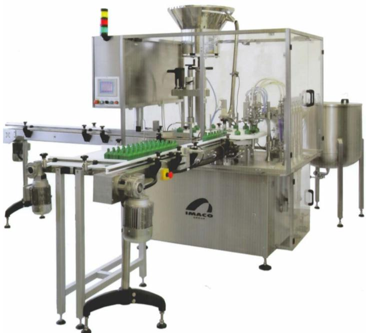
Fixează capacele prin presare sau înfiletare.
