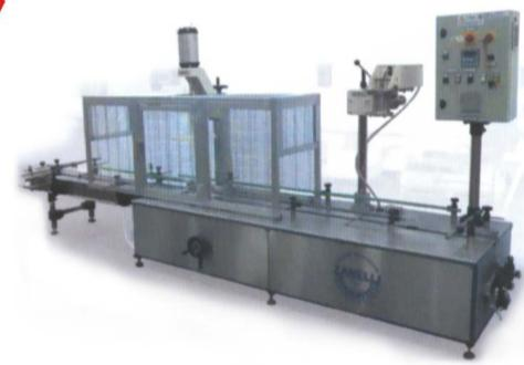
**Maşină umplere manuală cu dozare gravimetrică de la 4kg la 40kg**
