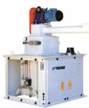
» Alimentator cu un s nec tubular tip NE/SC
