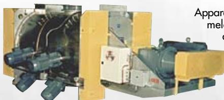
Appareil à l'avant-garde technologique, conçu pour transformer en grain les particules de poudre précédemment mélangées dans le granulateur, et humectées de liquides. Les grains ainsi obtenus ont la granulométrie désirée, et peuvent éventuellement être séchés dans l'appareil.
