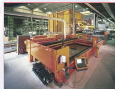
Echipament de taiere cu laser . Fabricare de produse standard si unicate .
