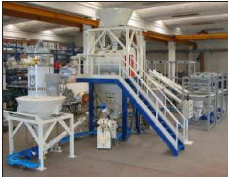
Impianto pilota di produzione premiscelati in polvere comprensivo di iniezione liquidi in pressione ed additivi vari.
