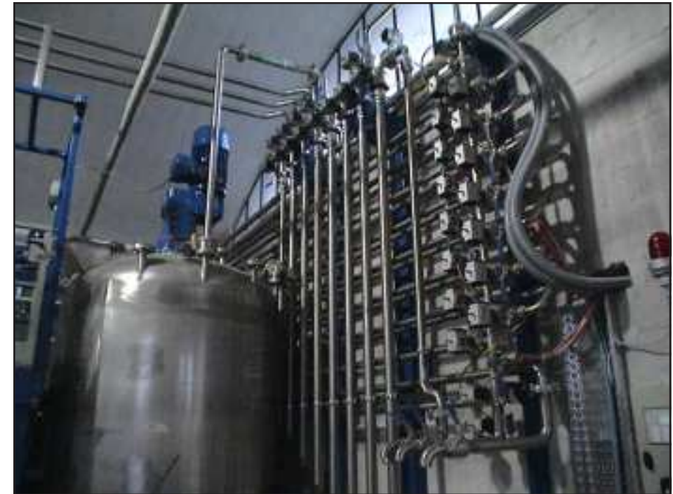
Impianto per la produzione di vernici a base solvente composto da agitatori e turbodispersori posizionati su celle di carico con alimentazione automatica delle materie prime liquide. Queste ultime sono caricate con sistema di piping dedicato per ogni diverso prodotto, sia per il carico che per lo scarico del prodotto stesso, controllato da software di supervisione integrato al sistema gestionale aziendale sviluppato dalla ditta Zanelli. L'impianto è conforme alle normative Atex in vigore.
