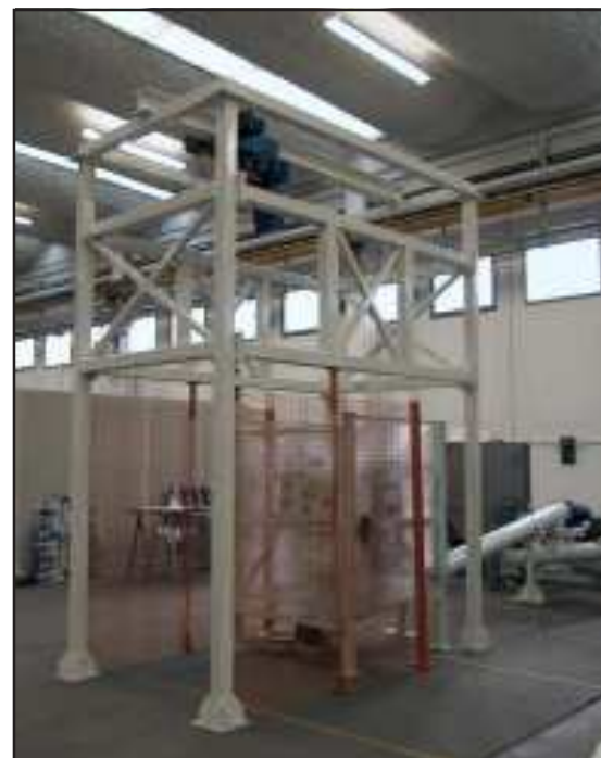
Stoccaggio polveri impaccanti in big-bag con trasporto e dosaggi automatici.
