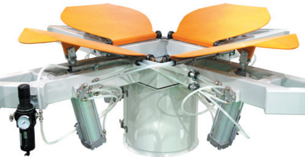
Particolari del sistema di sbattimento per prodotti a difficile scorrimento. Details of the bottom shaking system for difficult flowing products.
