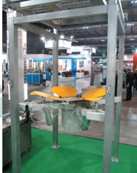
Particolari del sistema di sbattimento per prodotti a difficile scorrimento. Details of the bottom shaking system for difficult flowing products.
