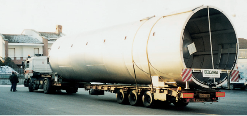
Trasporto eccezionale di un silos Ø mm. 3400. Special transport of a silos Ø mm. 3400.
