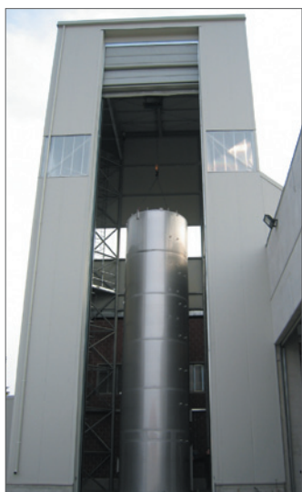
Torre di costruzione silos (altezza mt. 26). Silos building tower (height mt. 26).
